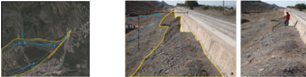
Figura 2: A la izquierda: Imagen satelital Google Earth en la cual puede observarse en líneas punteadas amarillas la llanura de inundación del río San Isidro, las líneas azules representa el sentido de escurrimiento del río, en línea naranja se puede observar el paredón de la presa San Isidro. A la derecha: Imágenes fotográficas en las cuales pueden observarse los depósitos de material aluvional de las últimas crecidas, puede verse que estos presentan similar altura que el dique. En líneas azules en la imagen A puede apreciarse la dirección de escorrentía del río, la altura se corresponde con 5.15 metros aproximadamente.
